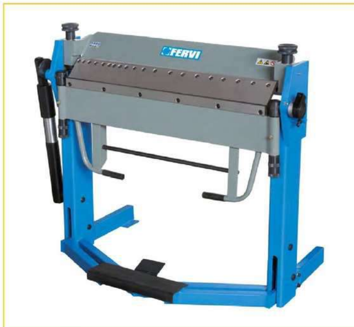
Sopra: FERVI propone la piegatrice Manuale P008 per le officine che richiedono versatilità e robustezza. Sotto: la calandra motorizzata 0285/75 di FERVI si distingue per la capacità di assicurare curvature uniformi e ripetibili nel tempo.
