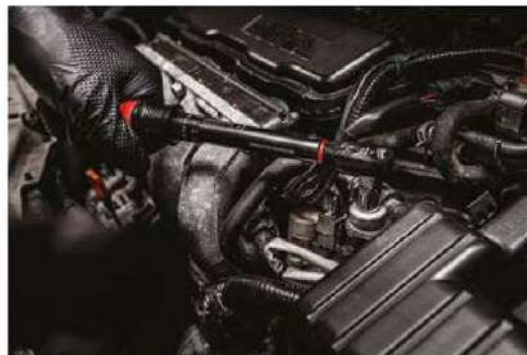
Milwaukee - La nuova gamma di chiavi dinamometriche è disponibile nei formati da 3/16", 1/4" e 1/2" e copre un intervallo di coppia da 5 a 340 Nm. Il meccanismo a scatto garantisce un feedback chiaro al raggiungimento della coppia. La molla non necessita di essere scaricata dopo l'uso: può restare sovrata sul valore desiderato, pronta per l'utilizzo successivo. Costruzione robusta, scala di lettura immediata e impugnatura ergonomica.
