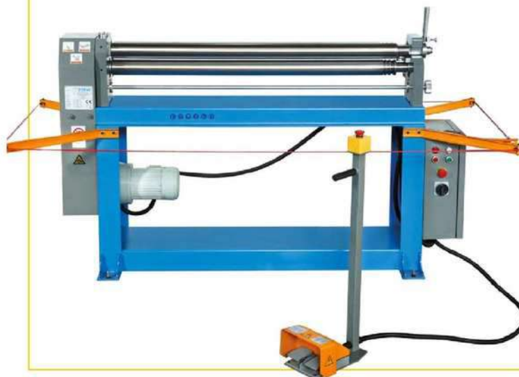
Sopra: FERVI propone la piegatrice Manuale P008 per le officine che richiedono versatilità e robustezza. Sotto: la calandra motorizzata 0285/75 di FERVI si distingue per la capacità di assicurare curvature uniformi e ripetibili nel tempo.
